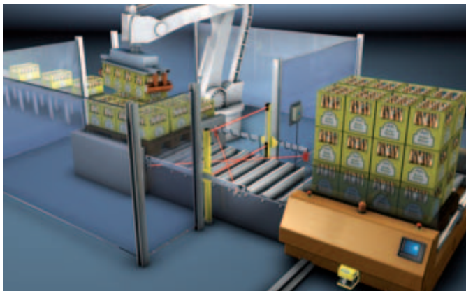
Los sistemas de transporte son una de las múltiples aplicaciones para los sistemas completos con funciones de muting y override; aquí puede verse una aplicación con MLDSET
