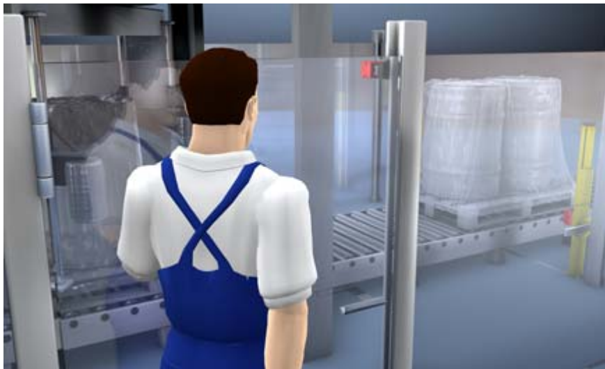
Interruptor de seguridad S200 en la puerta de una estación rebobinadora
