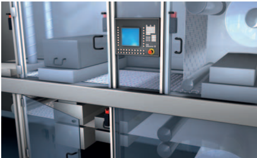
El controlador programable de seguridad MSI 100 supervisa como módulo principal Stand-alone los componentes de seguridad en las 20 entradas seguras, por ejemplo los bloqueos de seguridad de puertas con gacheta L100 en una máquina de blísters.
