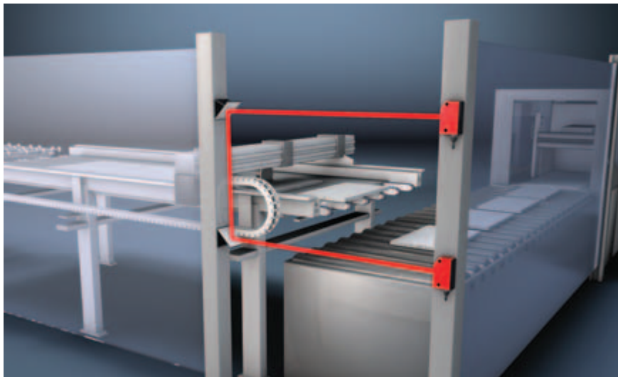
Protección de accesos con dispositivos de seguridad monohaz y espejos deflectores
