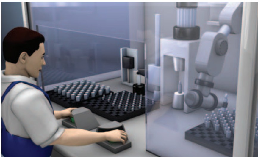
Protección de una zona de colocación con panel de control a dos manos y relé de mando a dos manos MSI-2H
