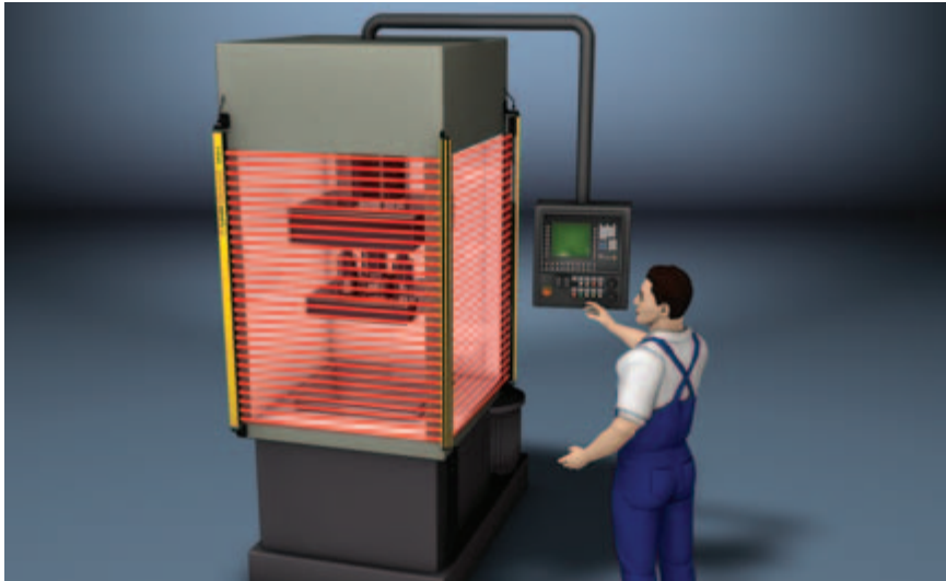
Protección multilateral de puntos peligrosos en una prensa mediante cortinas ópticas de seguridad con desviación de haces a través de un espejo deflector
