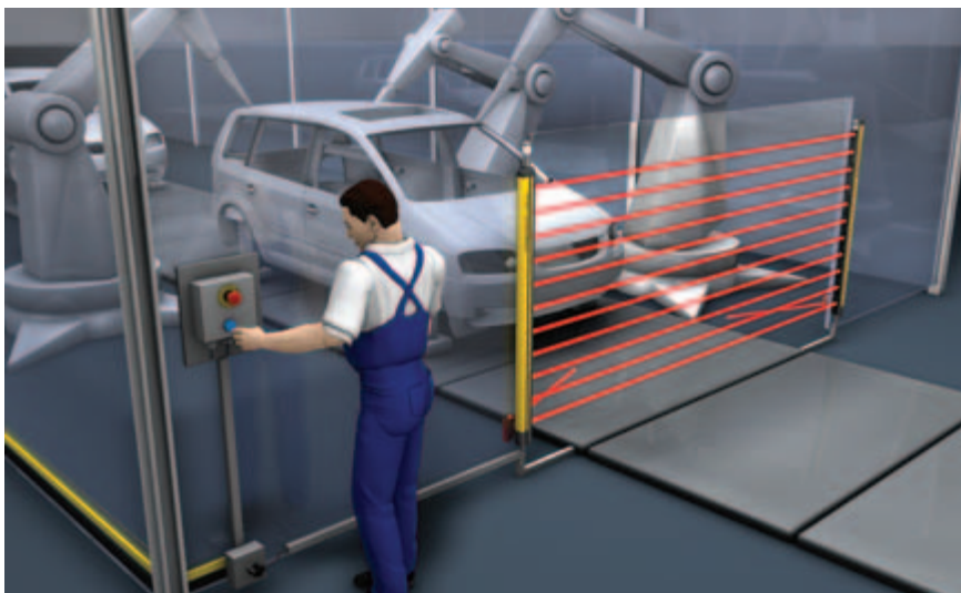
Salida automática de carrocería de la zona de trabajo mediante muting
