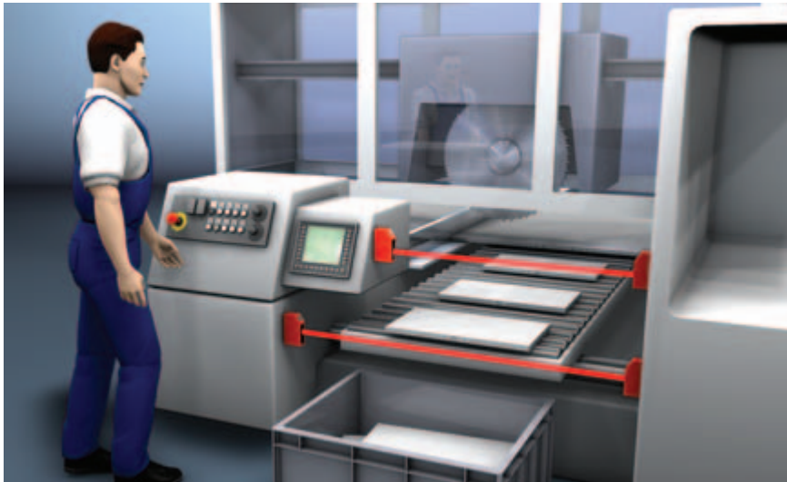
Protección con el dispositivo de seguridad monohaz SLSR 46B en una máquina para trabajar la madera
