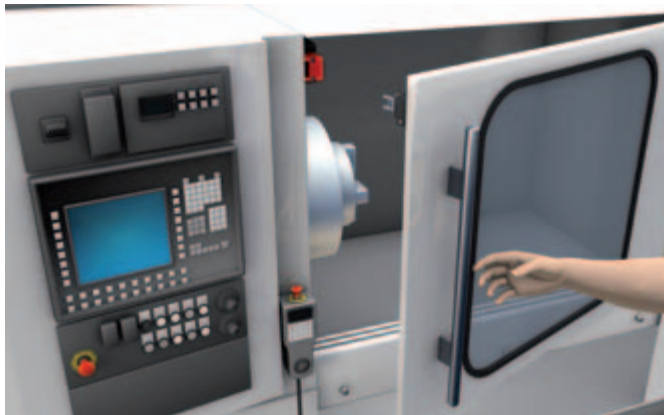
Bloqueo de seguridad de puertas con gacheta en un centro de mecanizado de metal con tiempos de marcha por inercia
