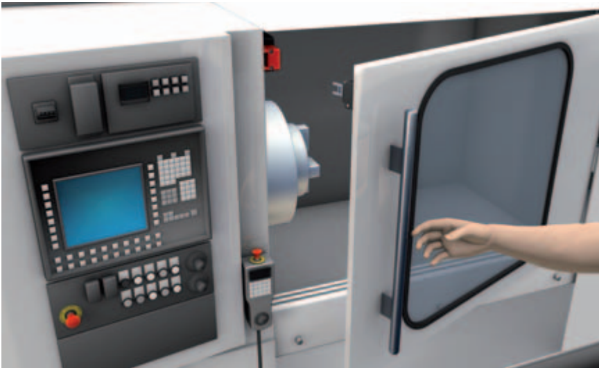
Bloqueo de seguridad de puertas con gacheta en un centro de mecanizado de metal con tiempos de marcha por inercia
