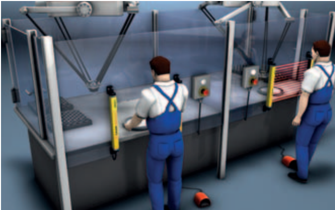
Sistema de control de los distintos componentes de seguridad con controladores programables de seguridad.
