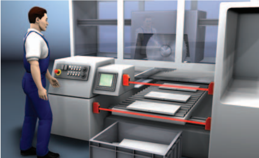
Protección de un centro de mecanizado para trabajar la madera con dispositivos de seguridad monohaz SLSR 46B y dispositivo de supervisión de seguridad MSI-T
