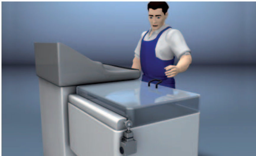
Interruptor de posición de seguridad en una máquina con dispositivo de protección y articulaciones giratorias: una aplicación típica, por ejemplo, en el mecanizado automático de piezas
