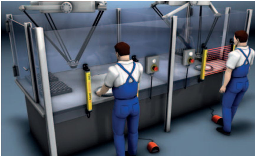
Controladores programables de seguridad como el módulo principal Stand-alone MSI 100 controlan la seguridad dentro de los procesos de fabricación automatizados.
